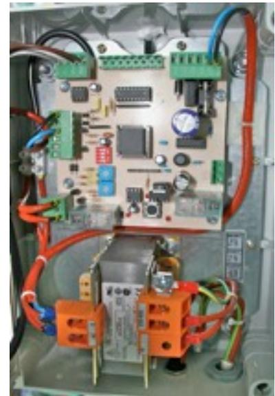
Questa emergenza entra in funzione dopo che il timer di allarme acustico e sonoro risulta funzionante per un tempo continuo superiore ai 90", a questo punto si avvia il conteggio del timer numero 2 che, trascorsi 4 minuti, toglie l'alimentazione al motore.
