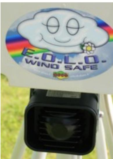
Dotato di display a LED indicante la velocità del vento in Km/h, Microlux e Sirena per avere un'allarme acustico e
